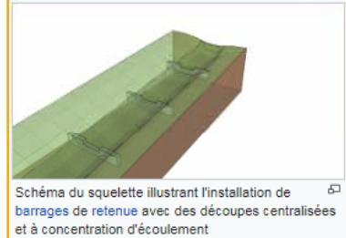
Schéma du squelette illustrant l'installation de barrages de retenue avec des découpes centralisées et à concentration d'écoulement
