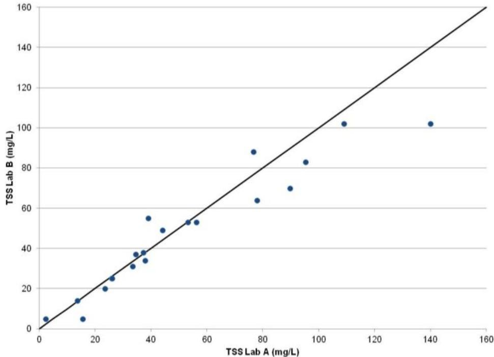
**Figure 5.1:** Lab A TSS values vs Lab B TSS values
